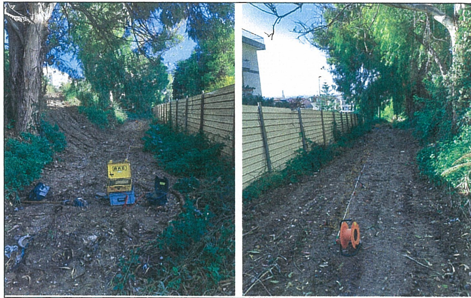
Foto 3 e 4: fase di esecuzione della prospezione sismica "M.A.S.W." denominata "M2" vista dagli estremi dello stendimento.
